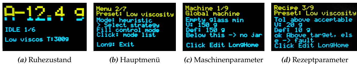
Abbildung 5.3: Fotos des OLED-Displays bei der Bedienung über den Drehencoder: Ruhezustand mit Nettomasse, Zustand und aktiver Voreinstellung, Hauptmenü mit markierter Auswahl der Dosierstrategie sowie je ein Beispiel aus den Untermenüs für Maschinen- und Rezeptparameter.
