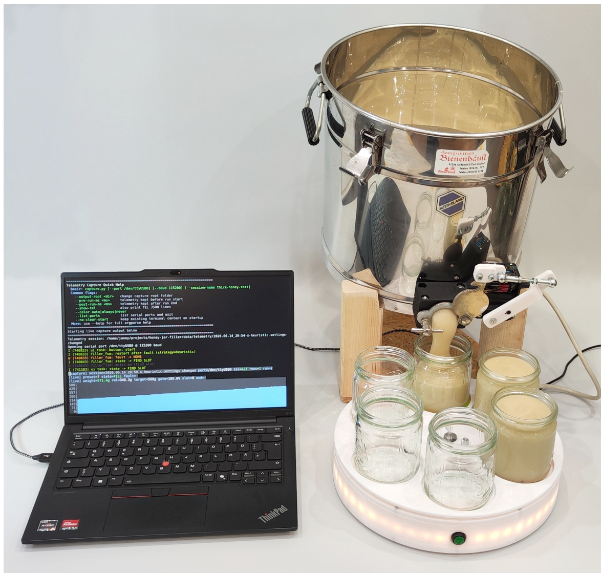
Abbildung 6.4: Gesamtansicht des Versuchsaufbaus während eines Abfüllvorgangs. Links ist der Laptop zur Aufzeichnung und Visualisierung der Telemetriedaten zu sehen, rechts die Abfüllanlage beim Befüllen eines Glases.
